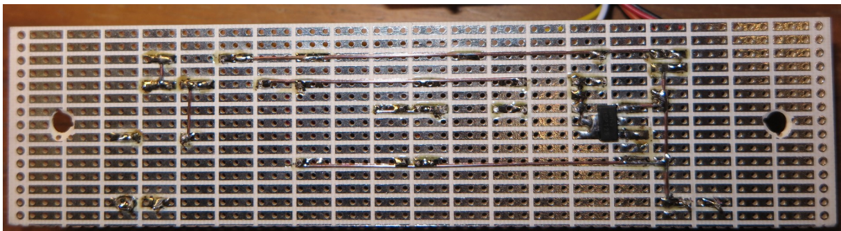
Simple-Arduino-Geiger auf einer Punkt-Streifenrasterplatine, Lötseite
